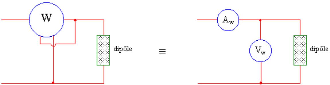
L'erreur systématique de mesure provient du courant dans le circuit tension.
