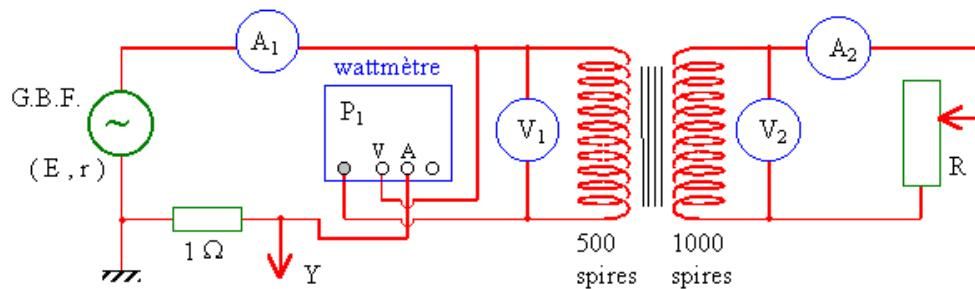
Pour le milliwattmètre, **attention** à utiliser la borne " mA " et non celle marquée " 10 A ".
