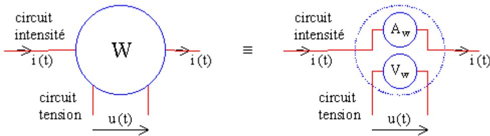
Lors de l'utilisation du wattmètre, il faut respecter **séparément** les calibres tension et intensité et non un hypothétique calibre puissance.
