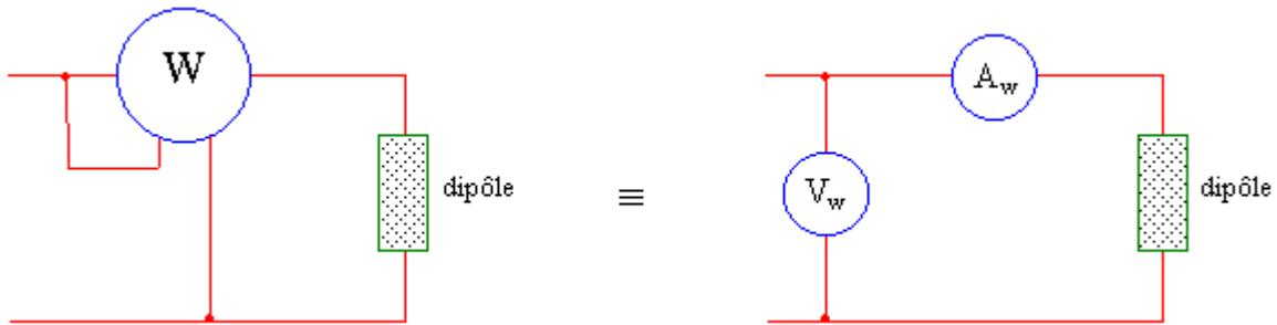
L'erreur systématique de mesure provient de la chute de potentiel aux bornes du circuit intensité.
